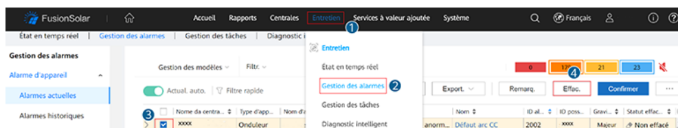
Figure 7-6 Effacement des alarmes
